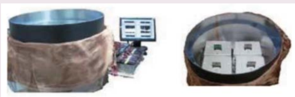
圖1 多通道電子式磁性免疫分析儀的實驗室原型機 (a) 側視圖 (b) 上視圖。
